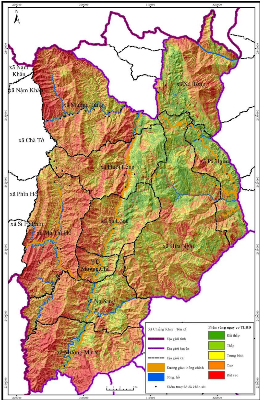
Hình 11. Sơ đồ phân bố các phân vùng cảnh báo nguy cơ trượt lở đất đá trong khu vực huyện Mường Chà.
